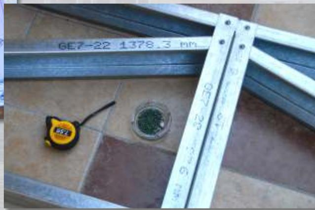
Производим 10 видов размеров стальных оцинкованных профилей толщиной от 0,35 мм до 0,6 мм для сухого монтажа (монтаж гипсокартонных перегородок и потолков, облицовка фасадов зданий).
